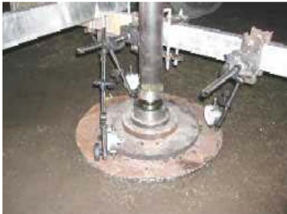
Prova di carico su piastra e diagramma risultante tipico (CNR – BU n. 146/1992 (1) )
