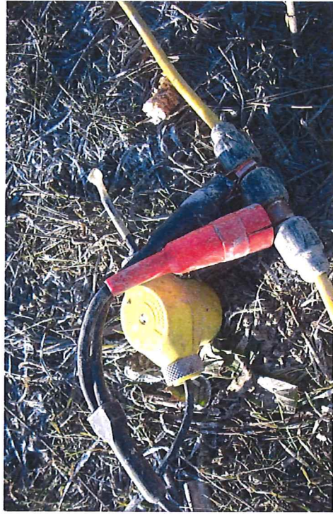
Figura 3 Geofono verticale e cavo sismico
