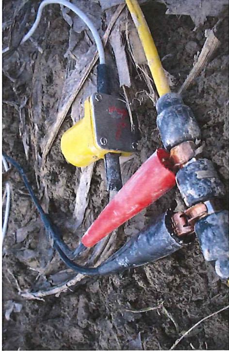
Figura 5 Geofono orizzontale e cavo sismico
