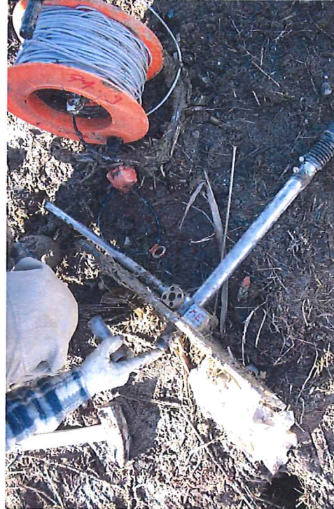
Figura 4 Fucile sismico e geofono starter
