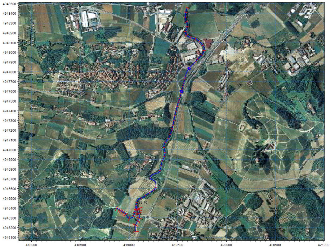
Figura 22 - Rappresentazione planimetrica di dettaglio del tratto di modello monodimensionale (MIKE 11).
