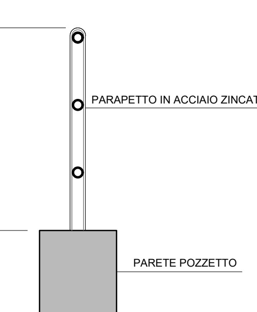
TIPOLOGICO PARAPETTO scala 1:20
