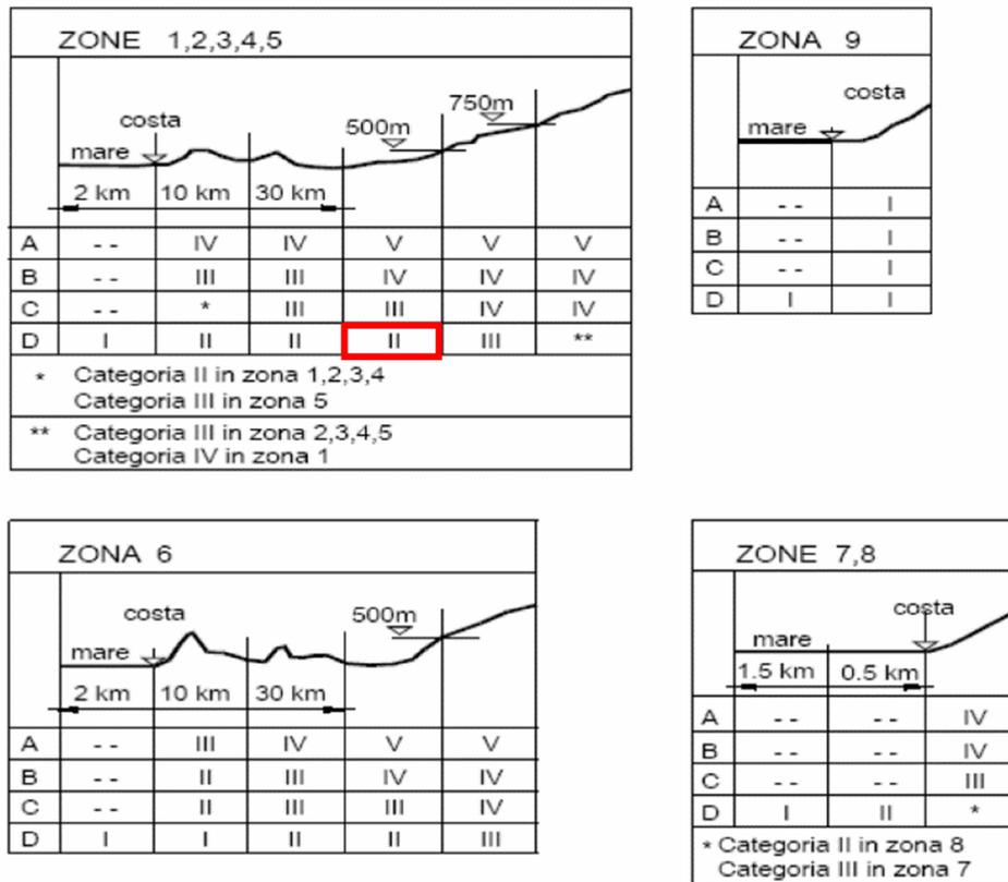
Figura 6 – Definizione della categoria di esposizione [Fig. 3.3.2 NTC 2018]
