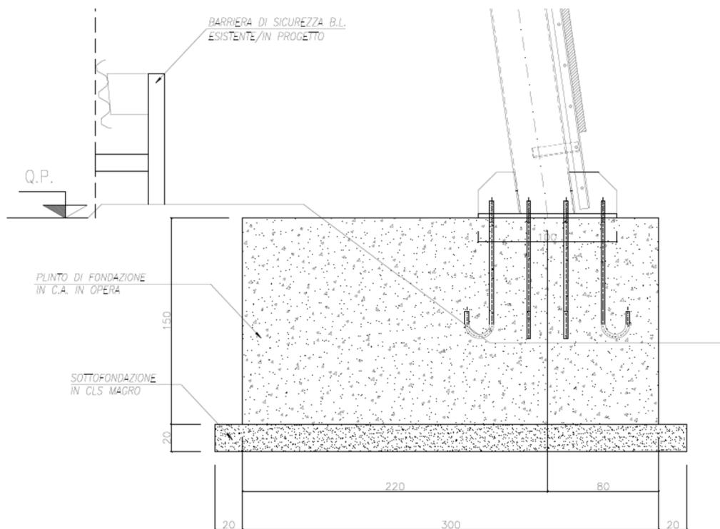
Figura 10 – Sezione plinto di fondazione
