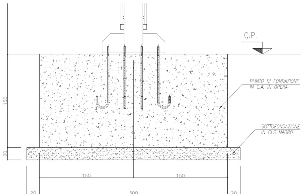
Figura 12 – Sezione plinto di fondazione
