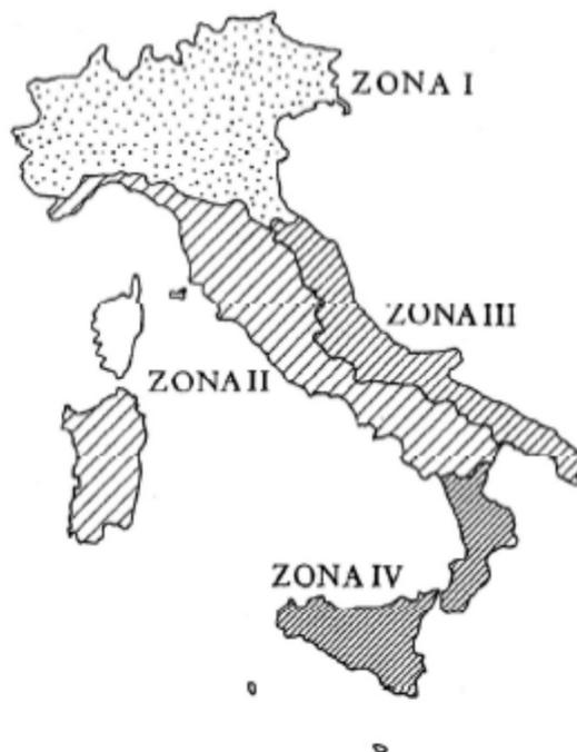
Figura 7 – Zone della temperatura dell'aria esterna
