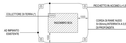
NOTA: L'IMPIANTO DI TERRA DEL BOX DOVRA' ESSERE COLLEGATO ALL'IMPIANTO DI TERRA ESISTENTE DELLA TRATTA
