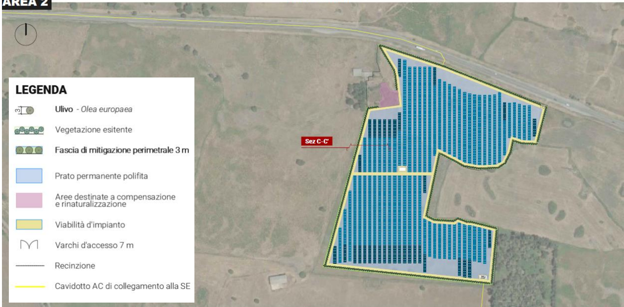
FIGURA 71 – PLANIMETRIA GENERALE SISTEMAZIONE A VERDE OPERE DI MITIGAZIONE (ESTRATTO DALL'ELABORATO GRAFICO SIN4-PDT11)
