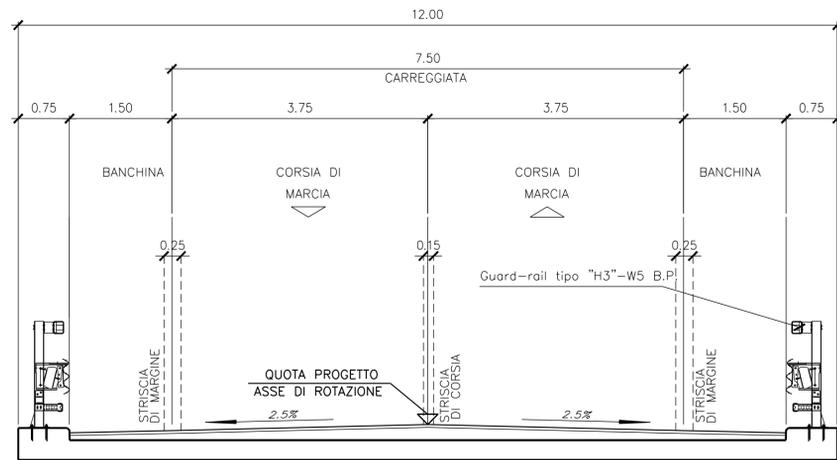
DETTAGLIO DELLA PAVIMENTAZIONE
