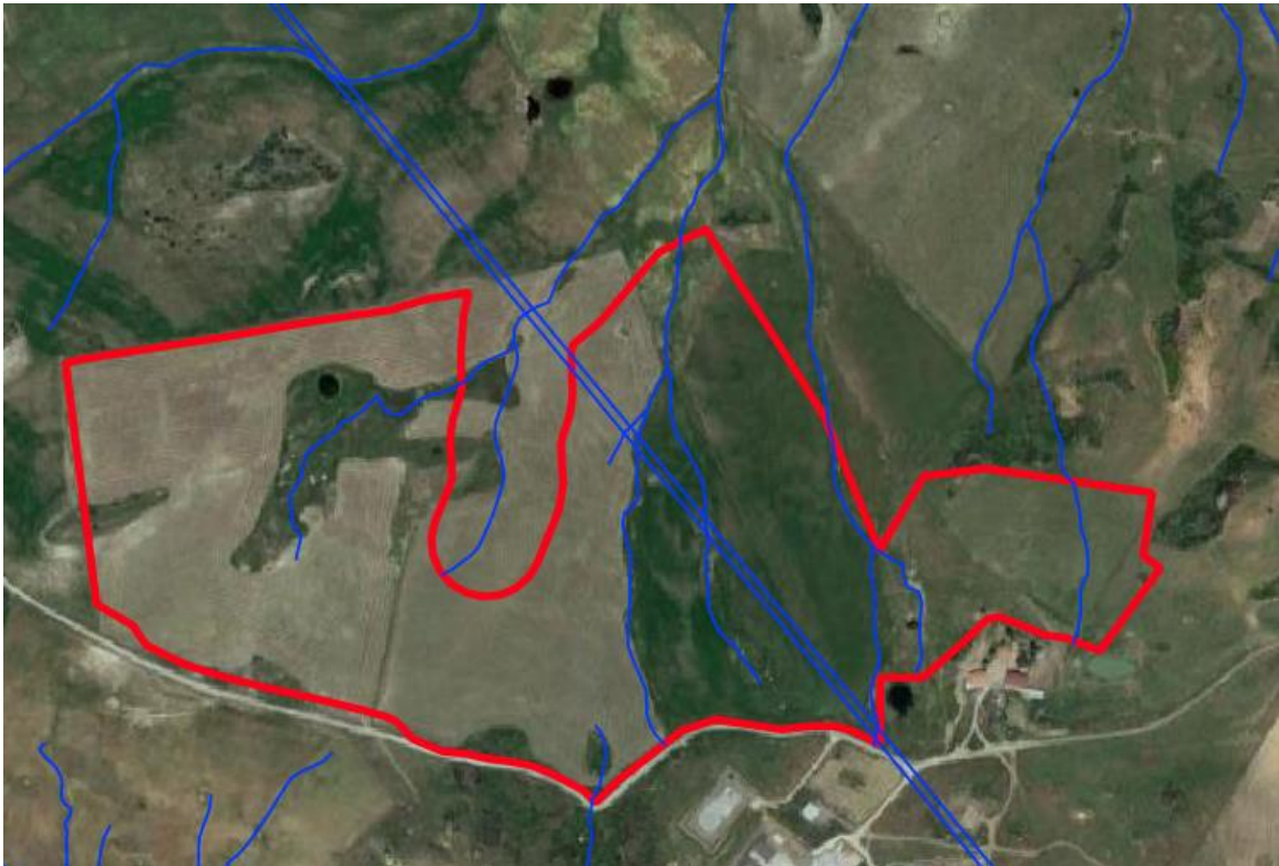
Figura 30: Inquadramento su ortofoto dei canali idrici perimetrati dal reticolo idrografico della Sicilia (in blu). In rosso la perimetrazione dell'area di impianto.
