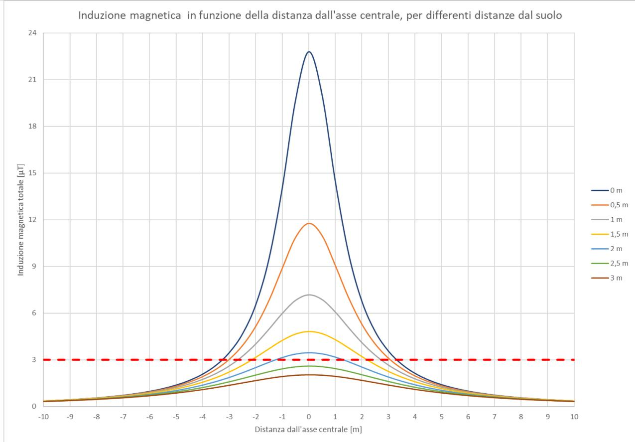
**Figura 13 – Andamento dell'intensità del campo magnetico nel caso posa di cinque terne di cavi nello stesso scavo al variare della distanza dal livello del suolo e della distanza dal baricentro delle terne di cavi. In rosso l'obiettivo di qualità imposto dalla normativa di settore**
