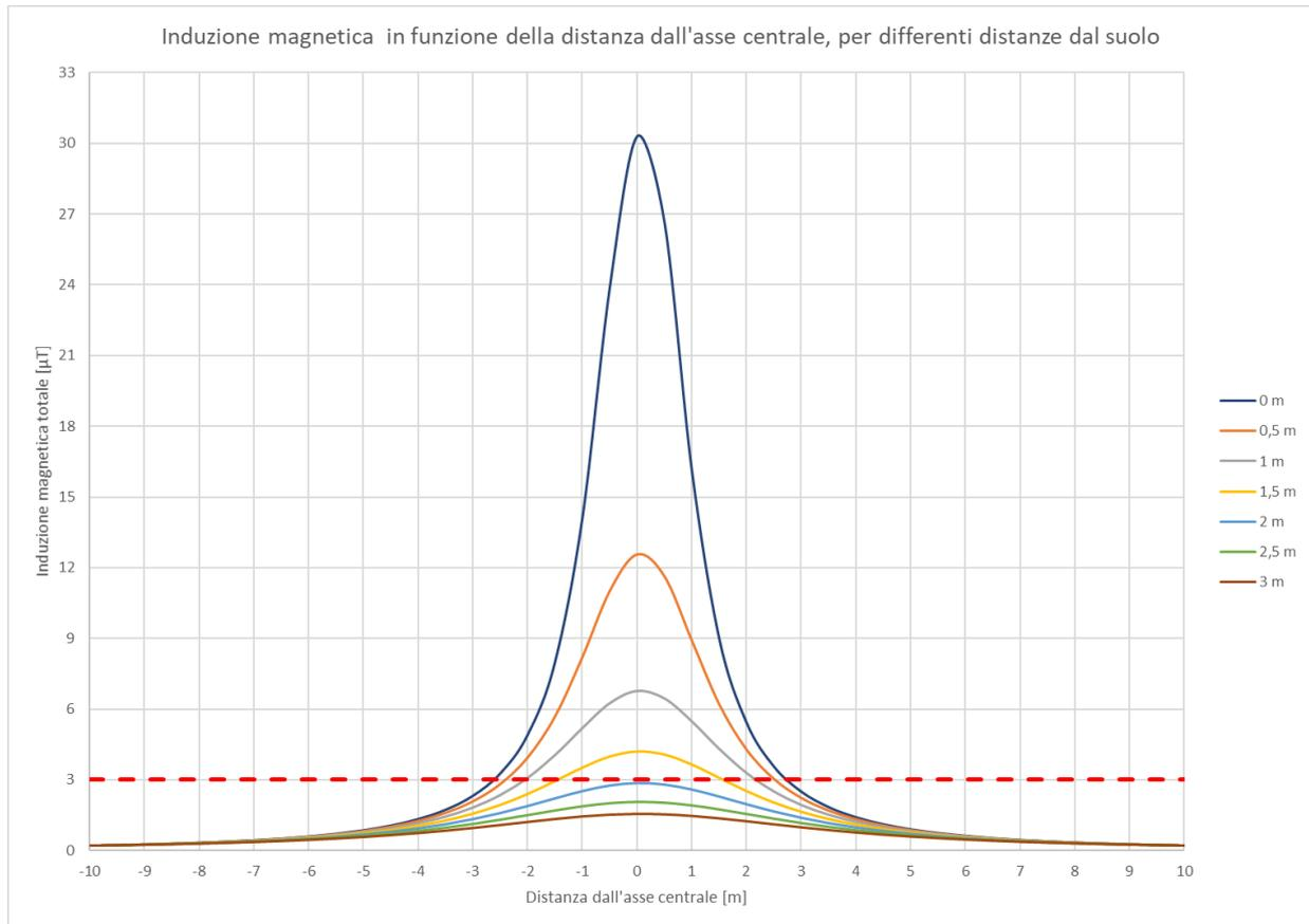
**Figura 11 - Andamento dell'intensità del campo magnetico nel caso posa di tre terne di cavi nello stesso scavo al variare della distanza dal livello del suolo e della distanza dal baricentro delle terne di cavi. In rosso l'obiettivo di qualità imposto dalla norma**
