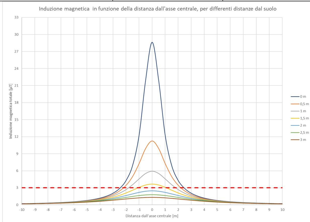
**Figura 9 - Andamento dell'intensità del campo magnetico nel caso posa di due terne di cavi nello stesso scavo al variare della distanza dal livello del suolo e della distanza dal baricentro delle terne di cavi. In rosso l'obiettivo di qualità imposto dalla norma**
