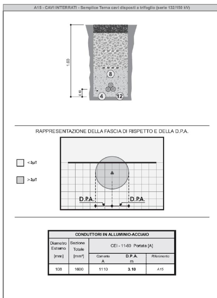
**Figura 14 - Linee AT in cavo interrato – DPA in accordo alla “Linea Guida per l'applicazione del § 5.1.3 dell'allegato al DM 29.5.2008” di e-Distribuzione**
