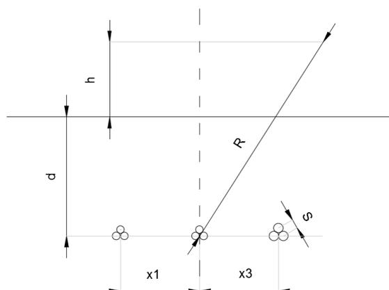
**Figura 10 - Sistema di riferimento per la valutazione dei campi magnetici nel caso di tre terne posate all'interno della medesima trincea**
