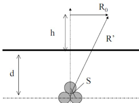
**Figura 7 - Illustrazione dei parametri geometrici per la definizione della DPA**
