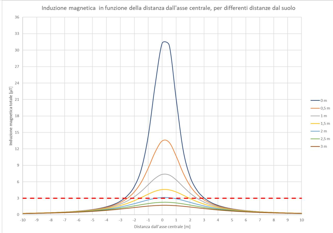
**Figura 12 – Andamento dell'intensità del campo magnetico nel caso posa di quattro terne di cavi nello stesso scavo al variare della distanza dal livello del suolo e della distanza dal baricentro delle terne di cavi. In rosso l'obiettivo di qualità imposto dalla normativa di settore**
