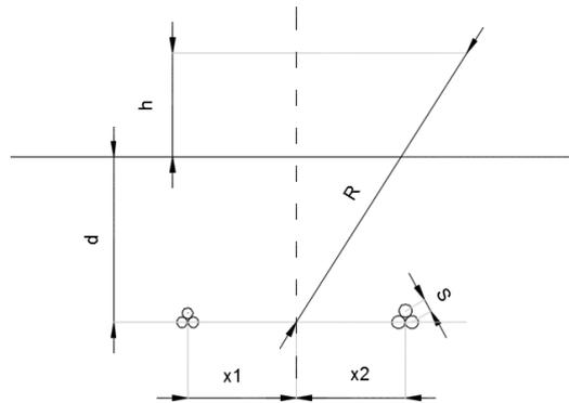
**Figura 8 - Sistema di riferimento per la valutazione dei campi magnetici nel caso di due terne posate all'interno della medesima trincea**
