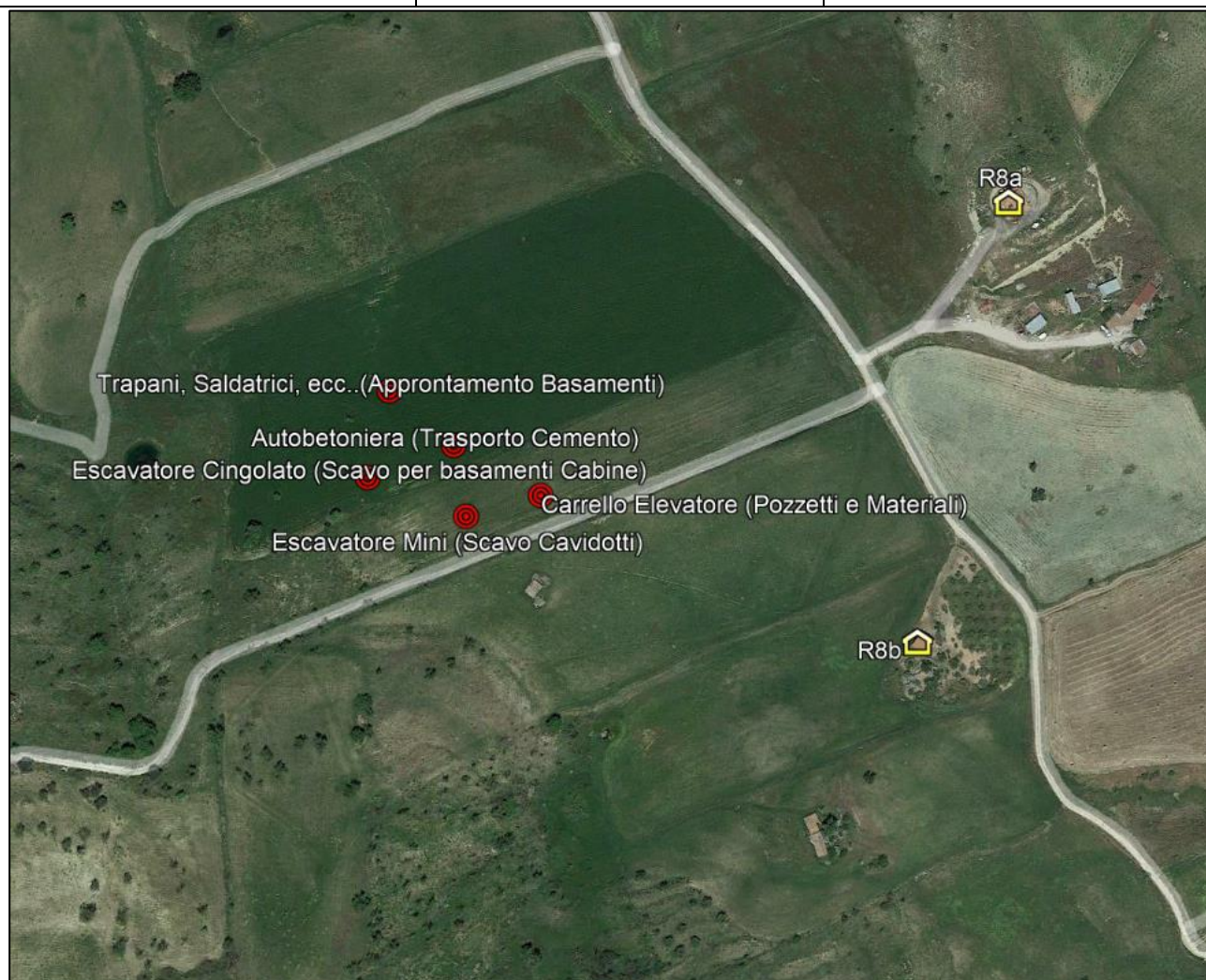
Fig.21: Posizionamento delle sorgenti Stazione SE: Opere Civili
