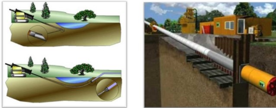
Figura 2: Immagini esplicative della perforazione teleguidata
