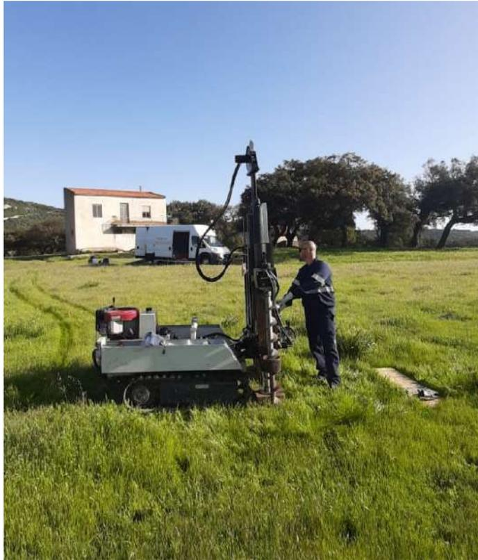
***Prova penetrometrica dinamica continua DPSH -2***
