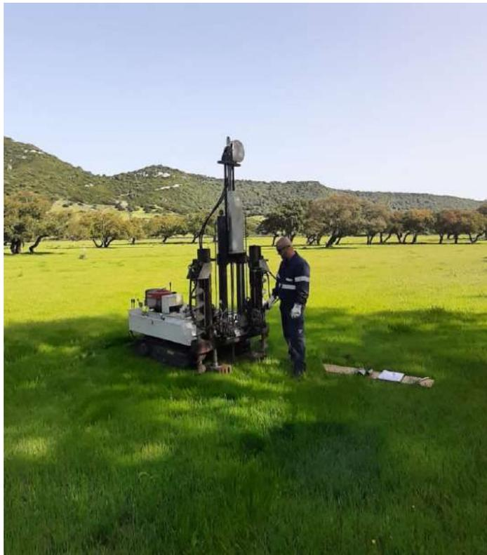
***Prova penetrometrica dinamica continua DPSH -3***
