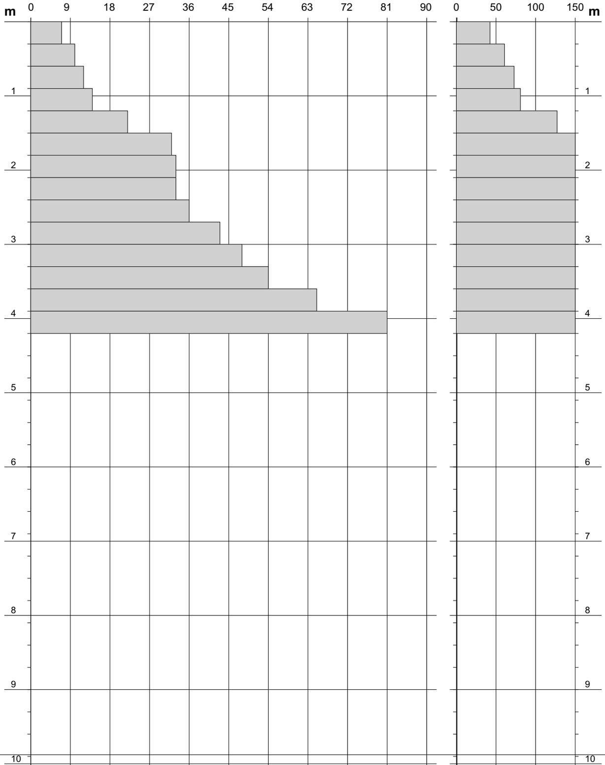
**PROVA PENETROMETRICA DINAMICA**
