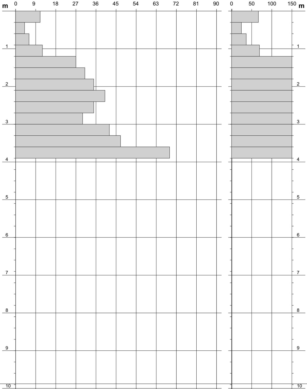
**PROVA PENETROMETRICA DINAMICA**
