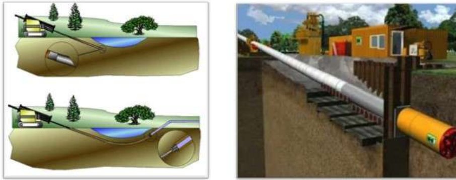
Figure 3-2. Immagini esplicative della perforazione teleguidata
