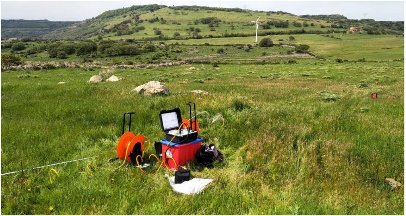
Stendimento SMT03-AG06 stazione tomografia elettrica
