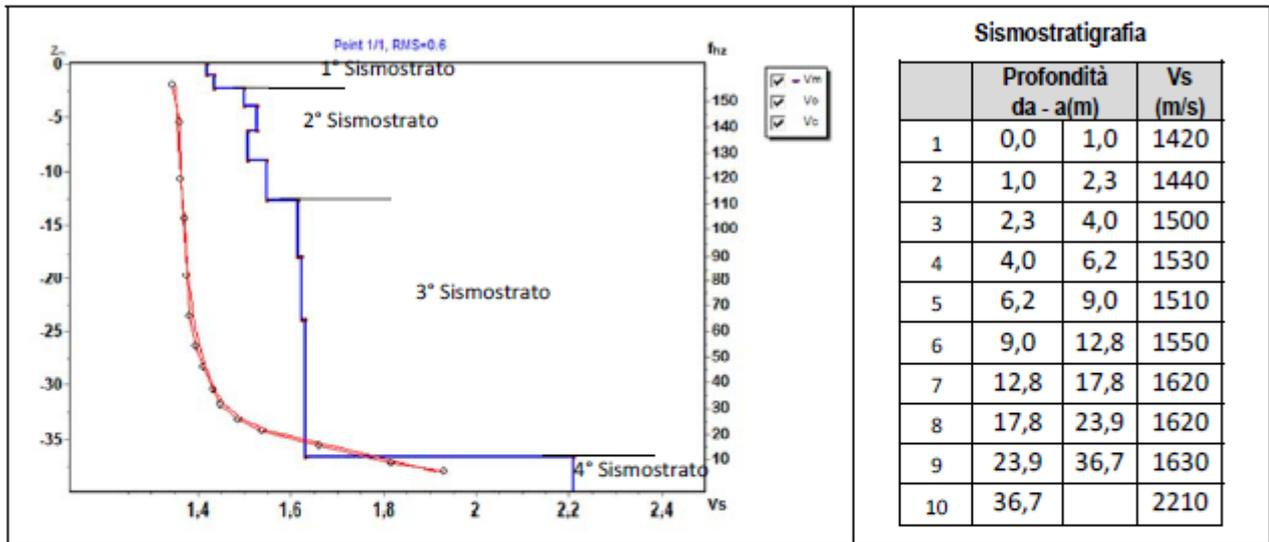
La classificazione del sottosuolo si effettua in base alle condizioni stratigrafiche ed ai valori della velocità equivalente di propagazione delle onde di taglio,  $V_{s,eq}$  (in m/s), definita dall'espressione
