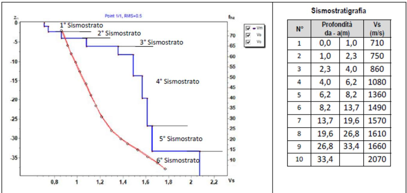
La classificazione del sottosuolo si effettua in base alle condizioni stratigrafiche ed ai valori della velocità equivalente di propagazione delle onde di taglio, Vs,eq (in m/s), definita dall'espressione
