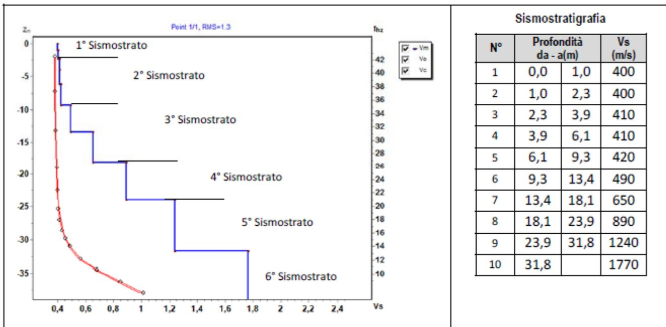
La classificazione del sottosuolo si effettua in base alle condizioni stratigrafiche ed ai valori della velocità equivalente di propagazione delle onde di taglio,  $V_{s,eq}$  (in m/s), definita dall'espressione
