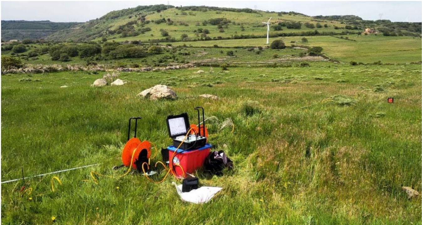
Stendimento SMT03-AG06 stazione tomografia elettrica
