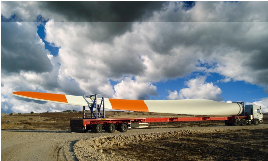
Figura 8: rappresentazione della fase di trasporto delle pale.
