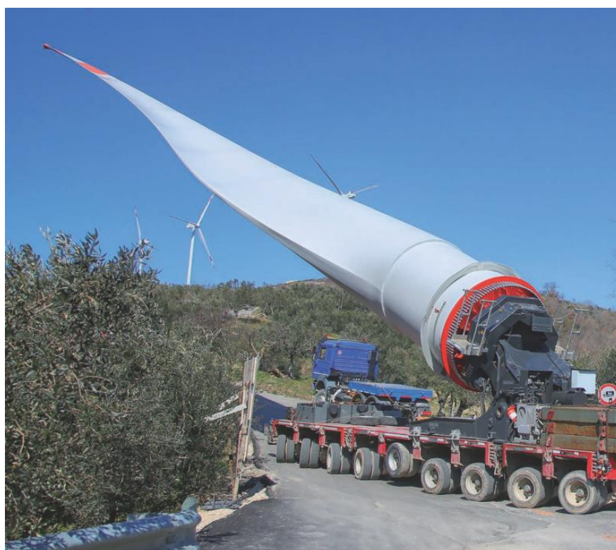
Figura 9: rappresentazione della fase di trasporto delle pale.
