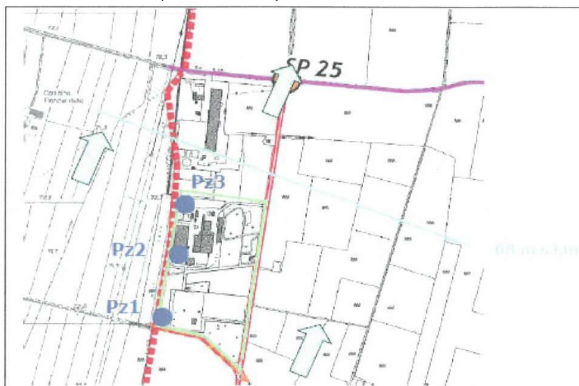
Figura 1-12 Andamento della falda e ubicazione dei piezometri
