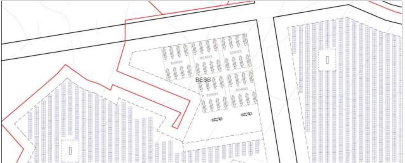
Fig. 4: Planimetria del BESS dell'impianto
