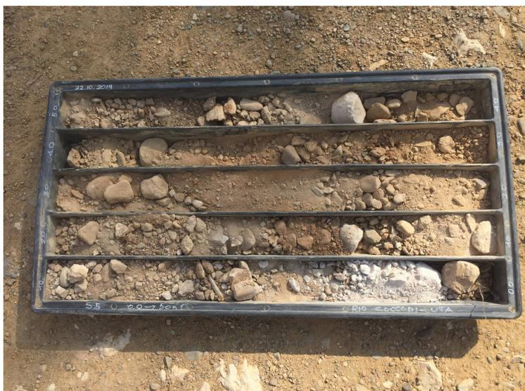
Esempio in cassetta (sciolte per rotazione del carotiere) - 0.0m / 5.0m
