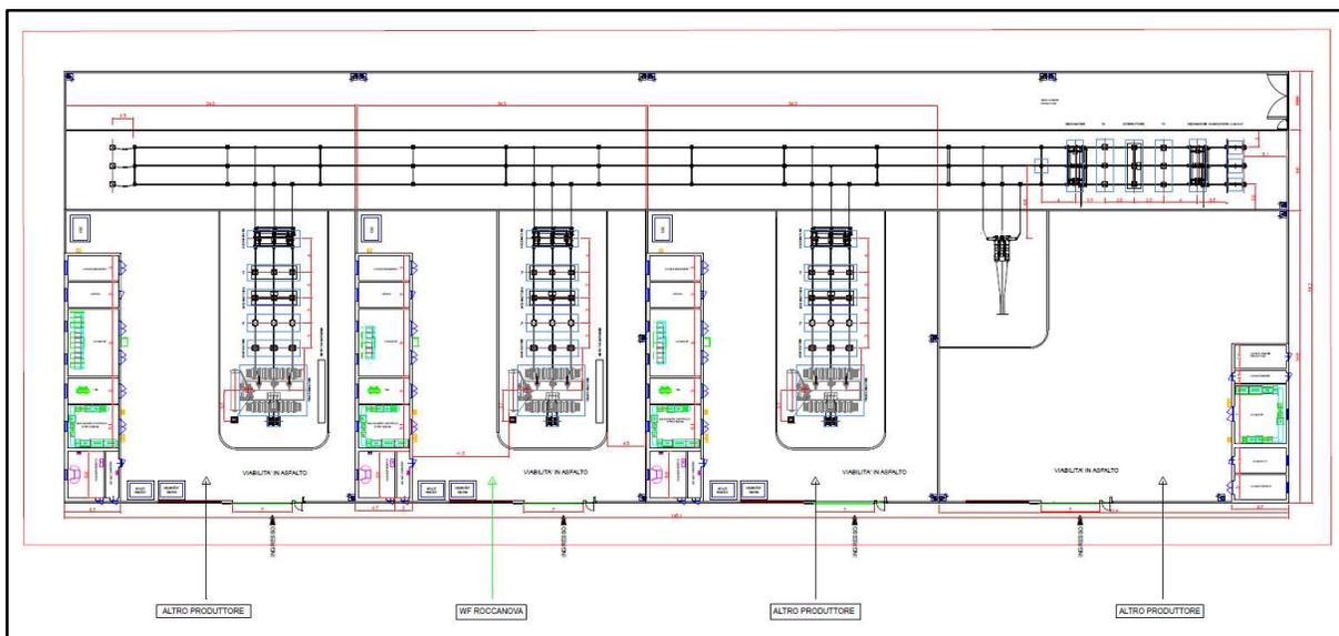
**Figura 2.3.4.2:** Planimetria elettromeccanica della sottostazione elettrica condivisa
