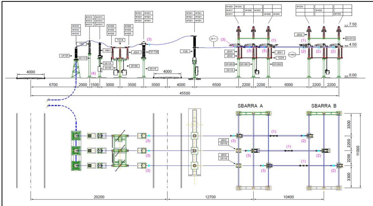
**Figura 2.3.6.3:** Planimetria e sezione elettromeccanica relative alle apparecchiature dello stallo 150 kV nella stazione Terna
