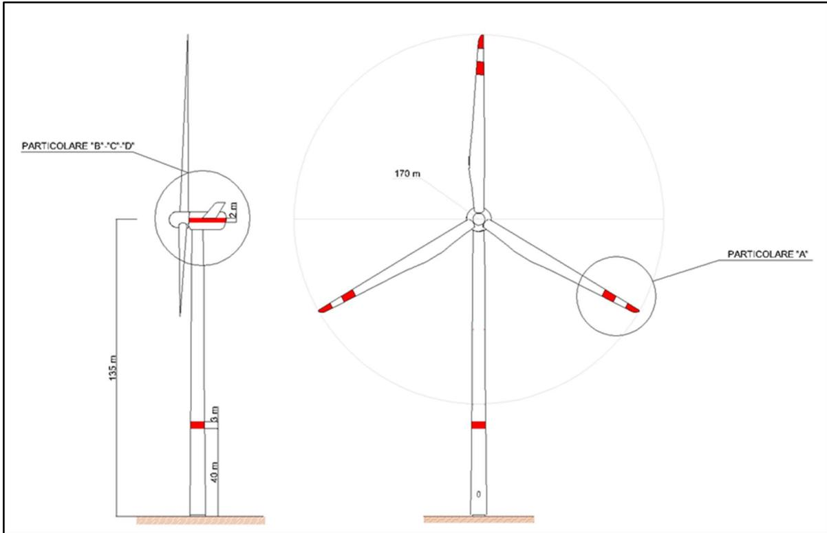
Figura 2.1.1: Profilo aerogeneratore SG170 – 6.2 MW
