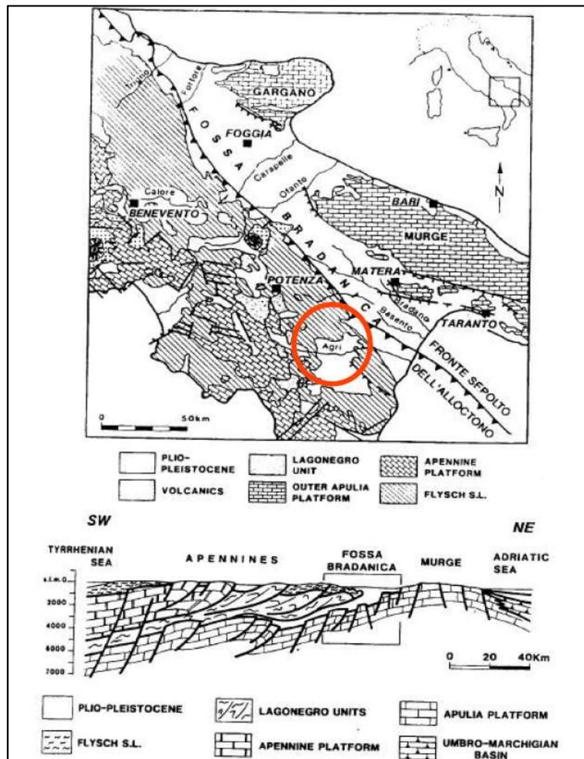
**Figura 4.3.1.1:** Carta geologica schematica e sezione geologica attraverso l'Appennino Meridionale e la Fossa Bradanica.
