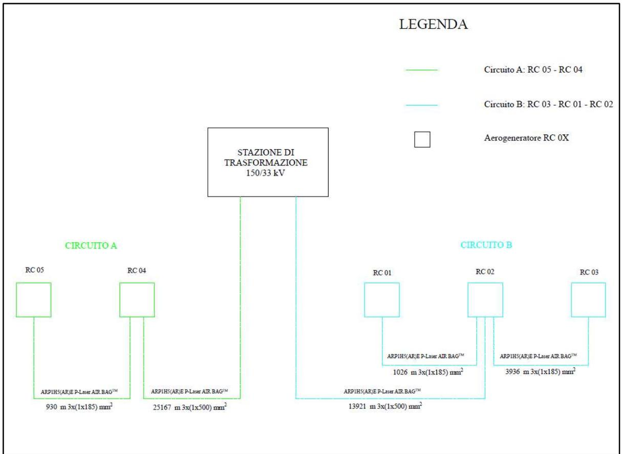
**Figura 2.3.3.1:** Schema a blocchi del Parco Eolico Roccanova
