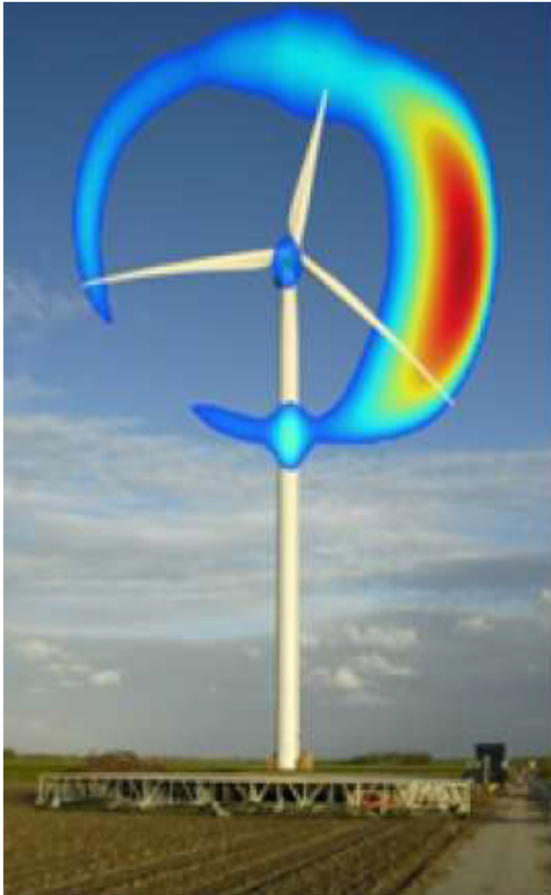
Rumore rilevato con SISTEMA BEAMFORMING
