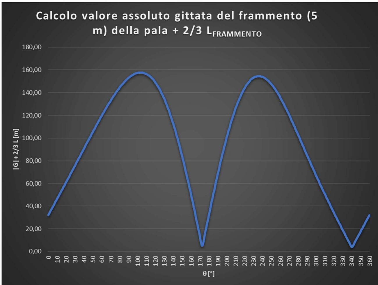
**Figura 8.2:** Grafico del valore assoluto della gittata del frammento della pala di lunghezza  $5\text{m} + 2/3 L_{FRAMMENTO}$
