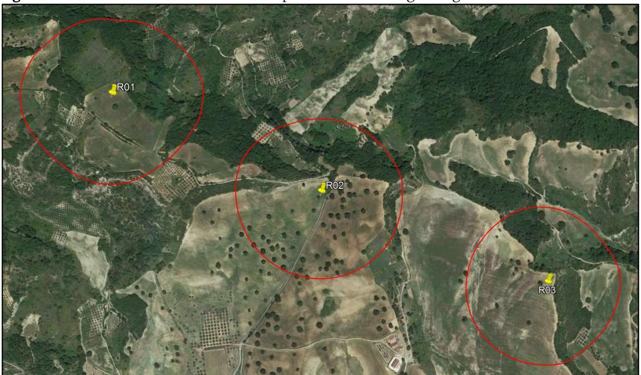
**Figura 9.2:** Aree interessate dalla rottura della pala relativamente agli aerogeneratori R 01, R 02 e R 03
