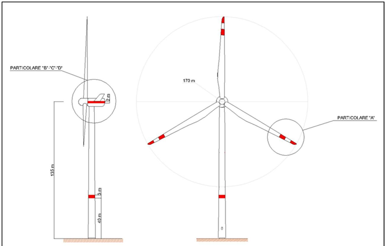
**Figura 2.1:** Profilo aerogeneratore SG170 – 6,2 MWp
