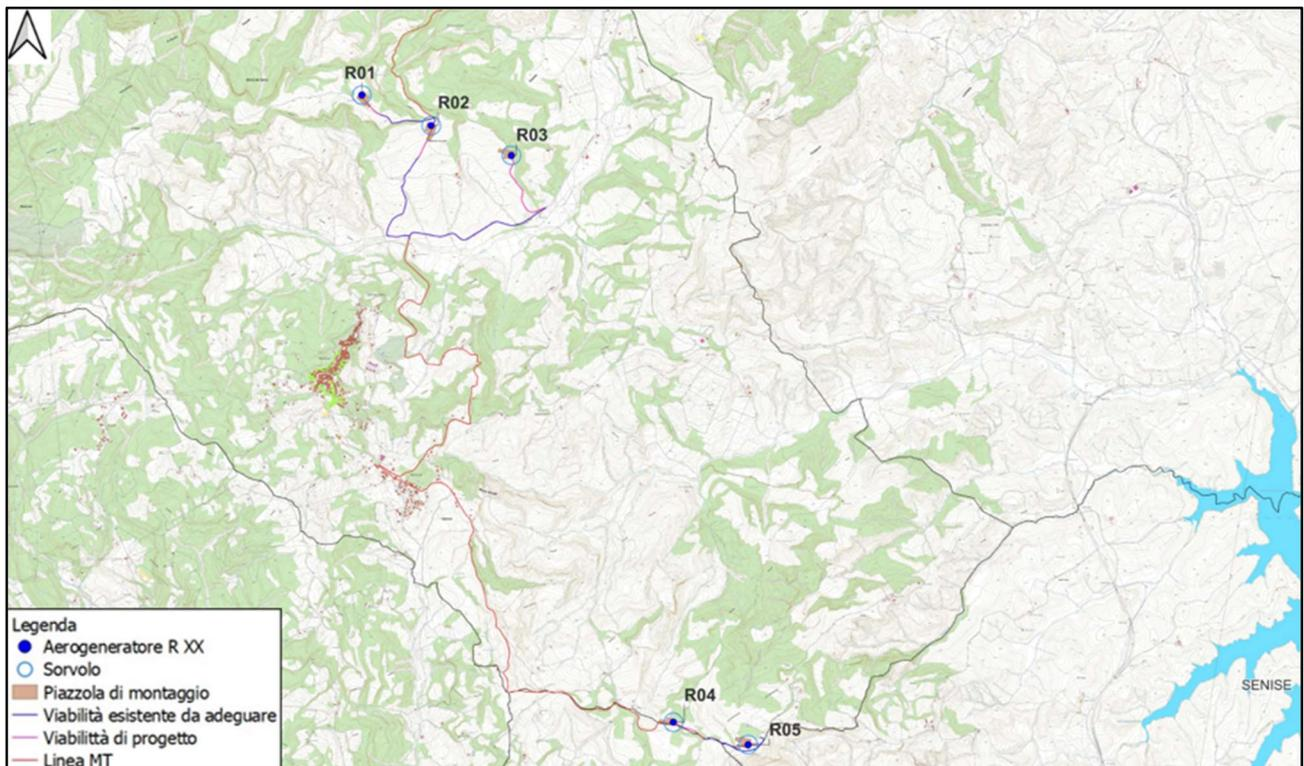
Figura 2.4: Layout dell'impianto eolico con aerogeneratori su CTR
