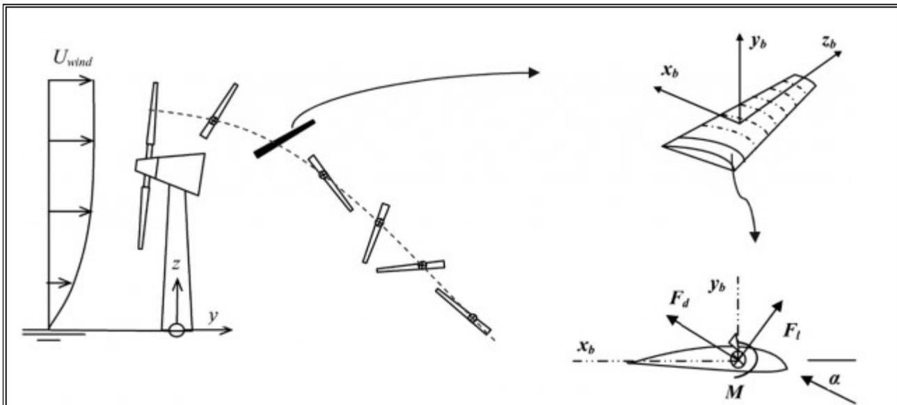
**Figura 5.1:** Traiettoria teorica pala in caso di rottura
