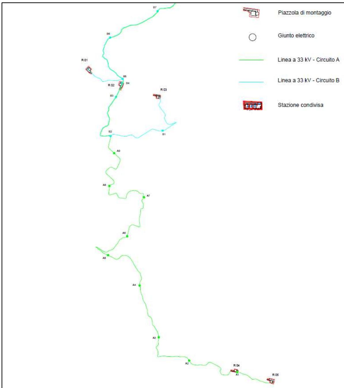
Figura 2.3.3.2: Planimetria di distribuzione linee MT di collegamento tra gli aerogeneratori
