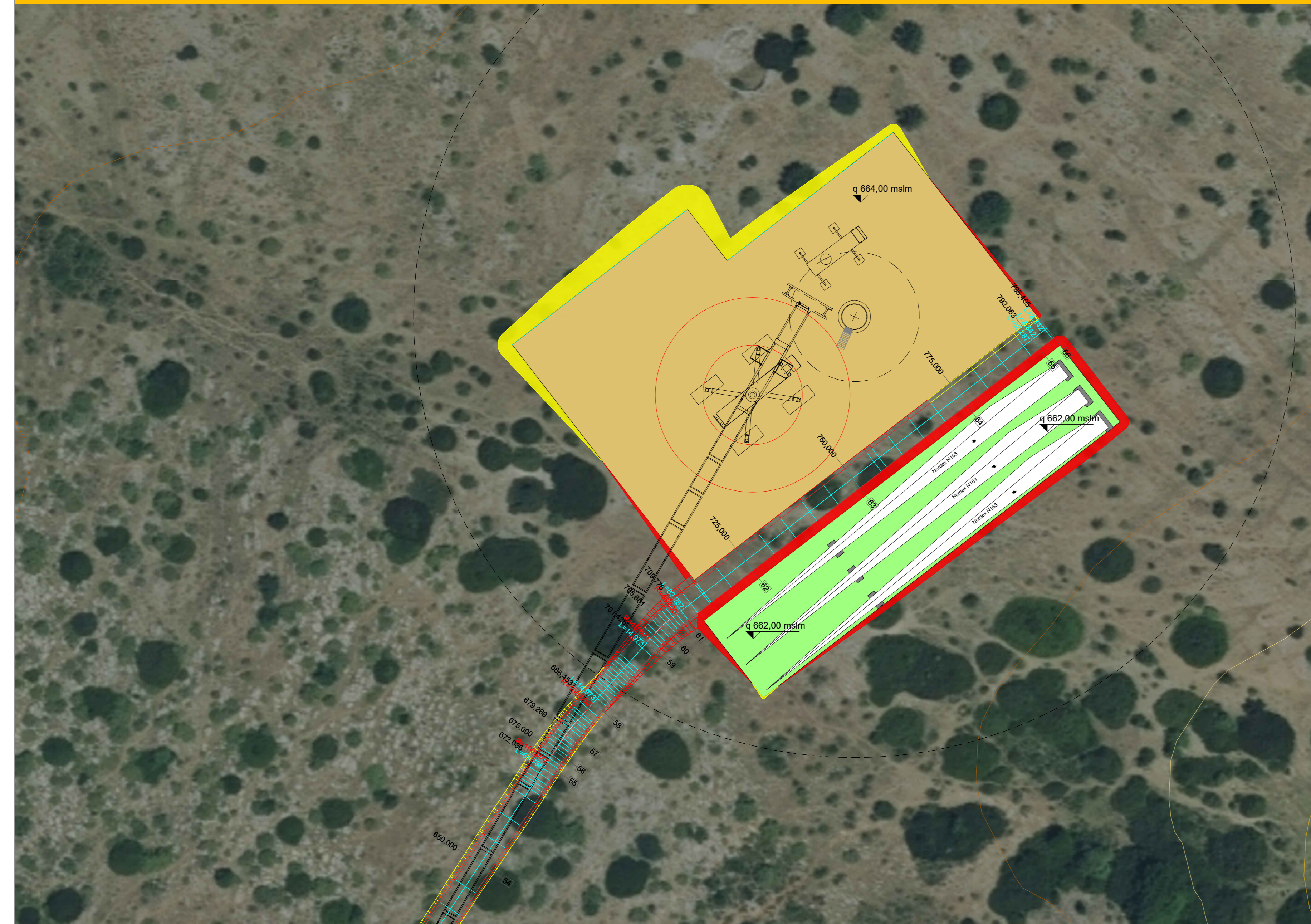
SE-12: VIABILITA' E PIAZZOLA IN FASE DI CANTIERE - PLANIMETRIA E SEZIONI SIGNIFICATIVE (tutte le sezioni sono raccolte nell'elaborato ELB.31-WTG12)
