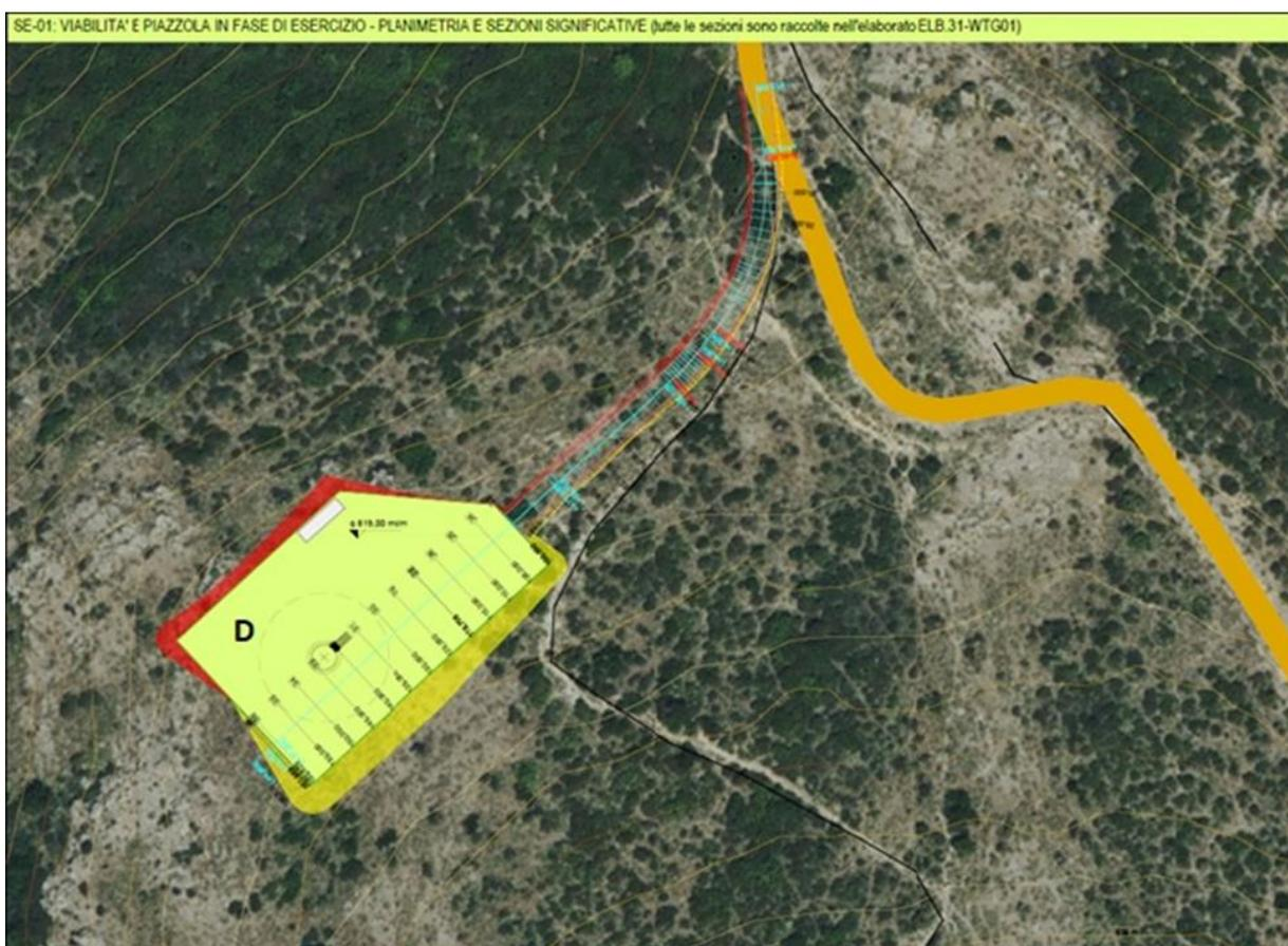
Fig. 10: SE – 01 Configurazione in fase di esercizio: Area D piazzola in fase di esercizio e cabina di raccolta
