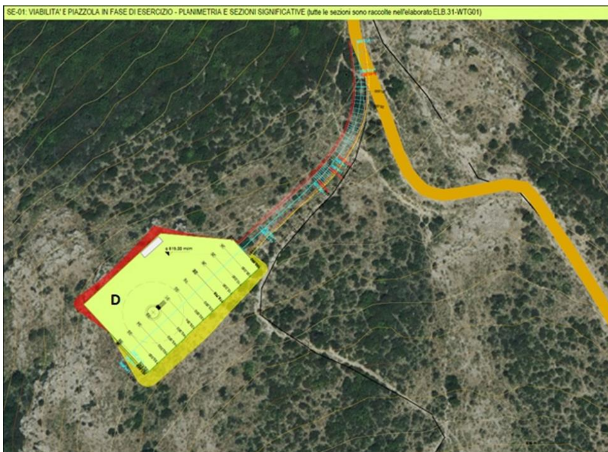
Fig. 58: SE – 01 Configurazione in fase di esercizio: Area D piazzola in fase di esercizio e cabina di raccolta
