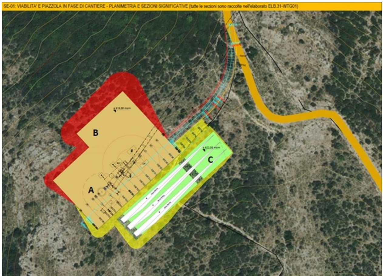
Fig. 57: SE - 01 Configurazione in fase di cantiere: aree aerogeneratore SE – 01 Vista dall'alto con aree A, B, C e gru da 200t
