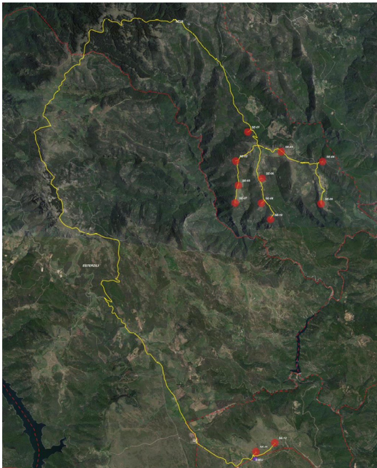
Fig. 4: Inquadramento area d'impianto, layout e connessione elettrica su ortofoto – in giallo i cavidotti interrati, cerchi in rosso gli areali degli aerogeneratori (non in scala).
