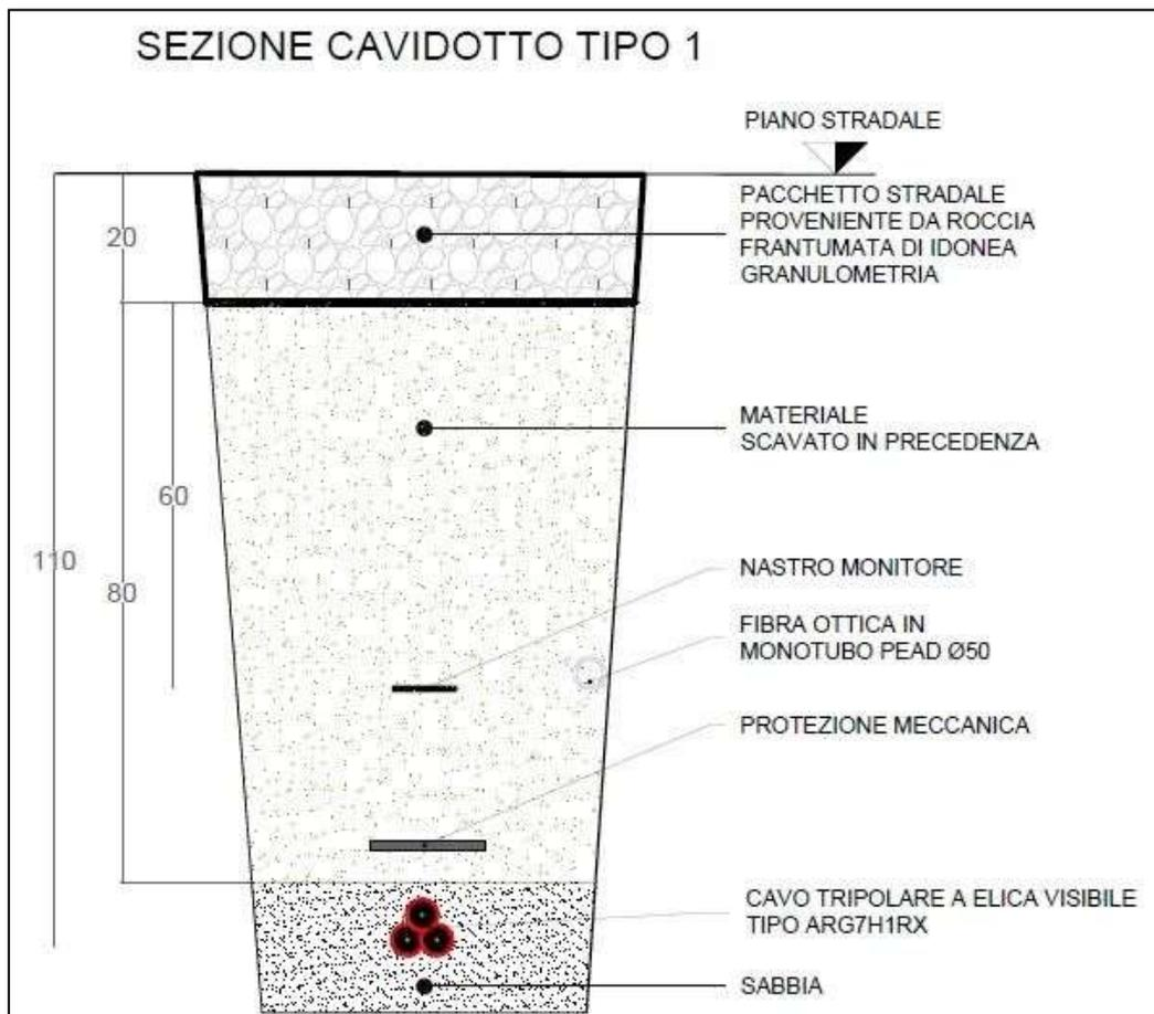
Figura 13 – Sezione-tipo di cavidotto.
