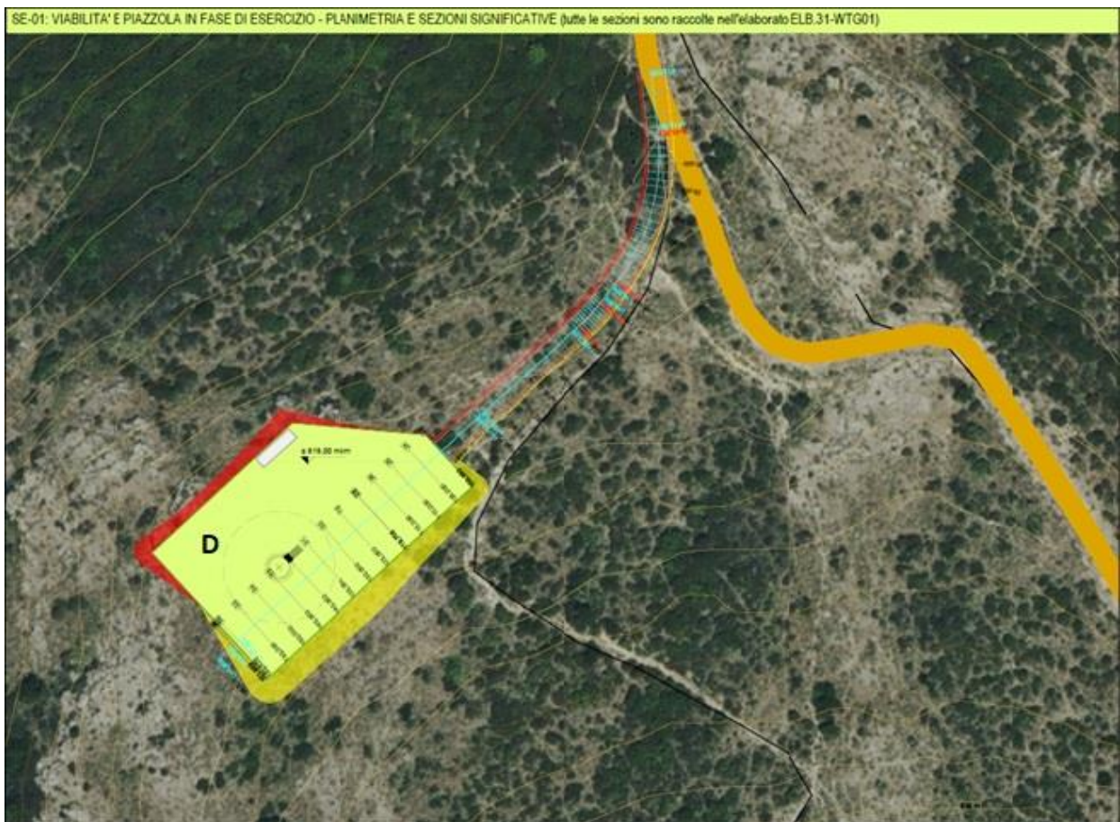
Fig. 4: SE-01 Configurazione in fase di esercizio: Area D piazzola in fase di esercizio e cabina di raccolta
