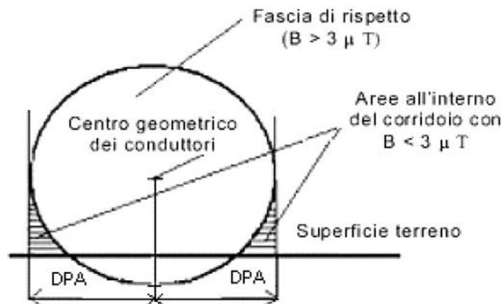
Figura 3.2- Calcolo della DPA per un elettrodotto
