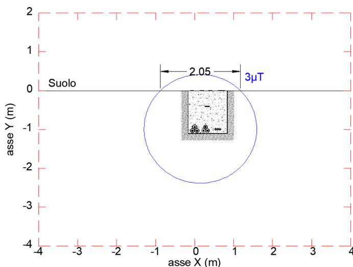
Figura 5.2 - Curva Equilivello 3μT – 2 terne di cavi a 36kV
