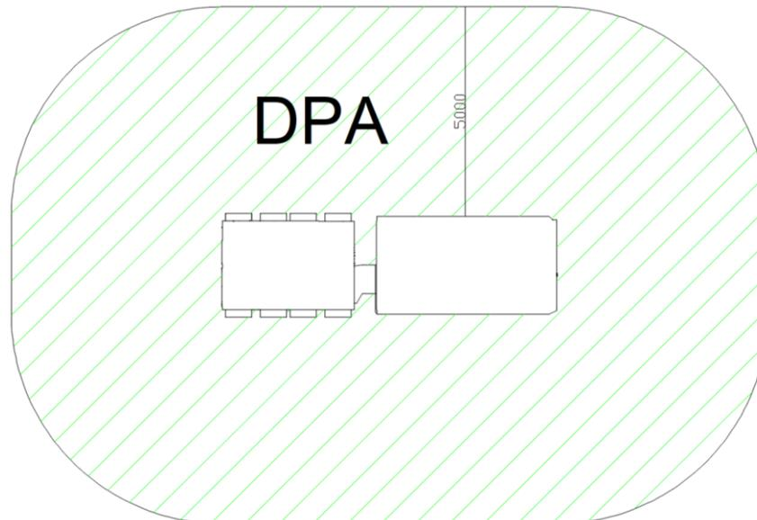
Figura 5.6 - DPA (in mm) per le cabine di conversione e trasformazione
