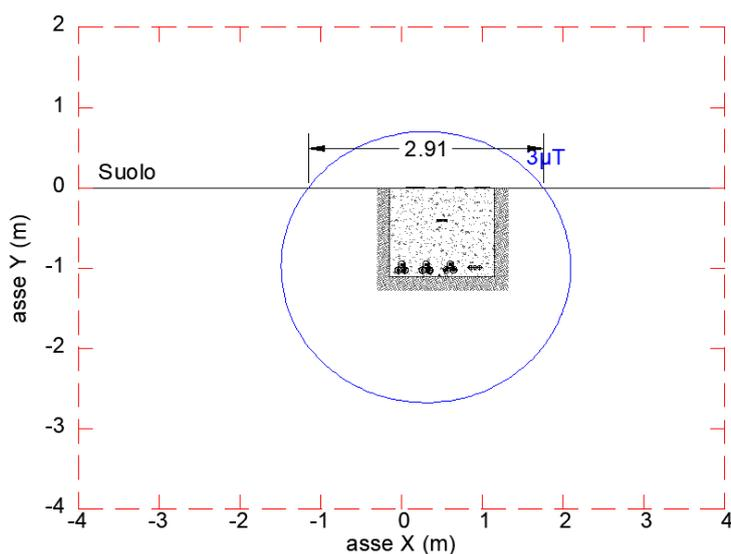
Figura 5.3 - Curva Equilivello 3μT – 3 terne di cavi a 36kV
