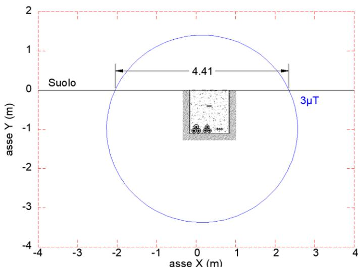
Figura 5.4 - Curva Equilivello 3 $\mu$ T – 2 terne di cavi a 36kV
