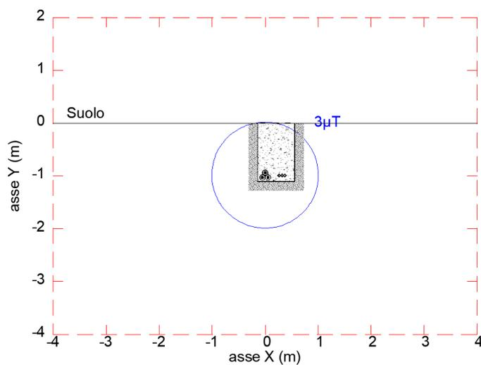
Figura 5.1 - Curva Equilivello 3μT – 1 terna di cavi a 36kV
