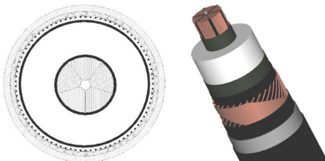
Figura 6 – Particolare Cavo AT
