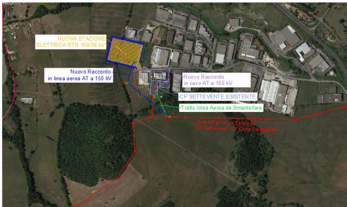
Figura 5 – Planimetria Impianto di Rete RTN
