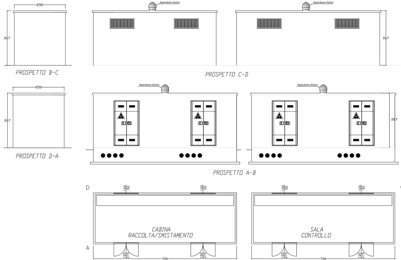
CABINA DI CONVERSIONE E TRASFORMAZIONE BT/MT - POWER STATION
