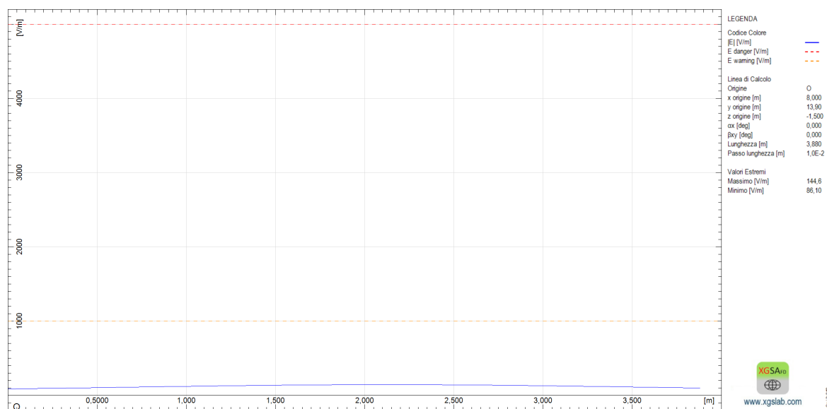
Profilo Campo Elettrico ad altezza 1,5 m
