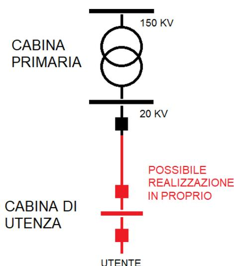
La linea elettrica esercita alla tensione di 20 kV e sarà realizzata in cavo interrato di tipo RG7H1M1X (3x1Cu150 mm<sup>2</sup>), posato secondo i criteri rappresentati in figura:
