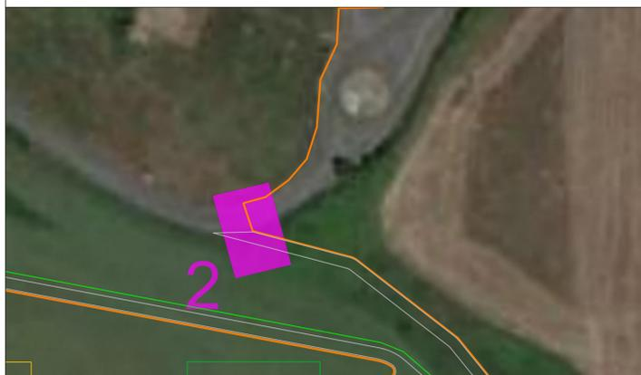
Il tracciato del cavidotto MT di connessione alla rete interferisce con il sistema di raccolta delle acque meteoriche della sede stradale. Il passaggio del cavidotto avverrà al di sotto delle cunette ad una distanza non inferiore a 30 cm prevedendone la protezione mediante riempimento in cls per un tratto di lunghezza estesa a non meno di un metro dal bordo delle cunette. Al termine delle operazioni di scavo la cunetta verrà ripristinata allo stato originario.
