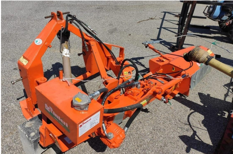
(Fresatrice interceppo. Il dispositivo che fa evitare all'attrezzo di urtare i sostegni delle stringhe)
