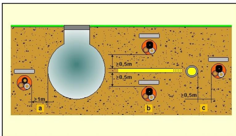
Incroci tra cavi di energia e tubazioni di gas con densità non superiore a 0,8 non drenante con pressione massima di esercizio > 5BAR
