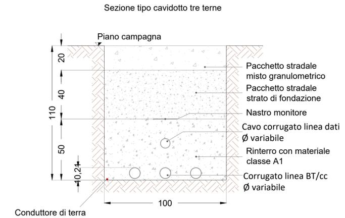
**SEZIONE TIPO CAVIDOTTO BT SU STRADA ASFALTATA**
