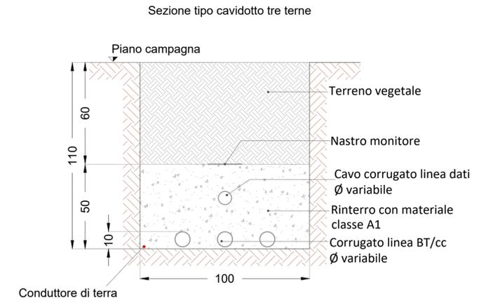
**SEZIONE TIPO CAVIDOTTO BT SU STRADA STERRATA**
