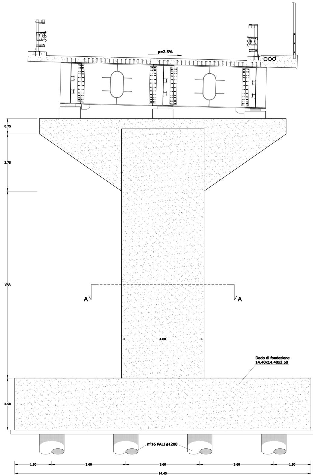
PROSPETTO PILA IN DIREZIONE LONGITUDINALE
