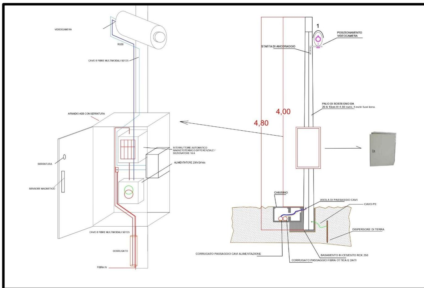
Figura 2 Tipologia palo da installare
