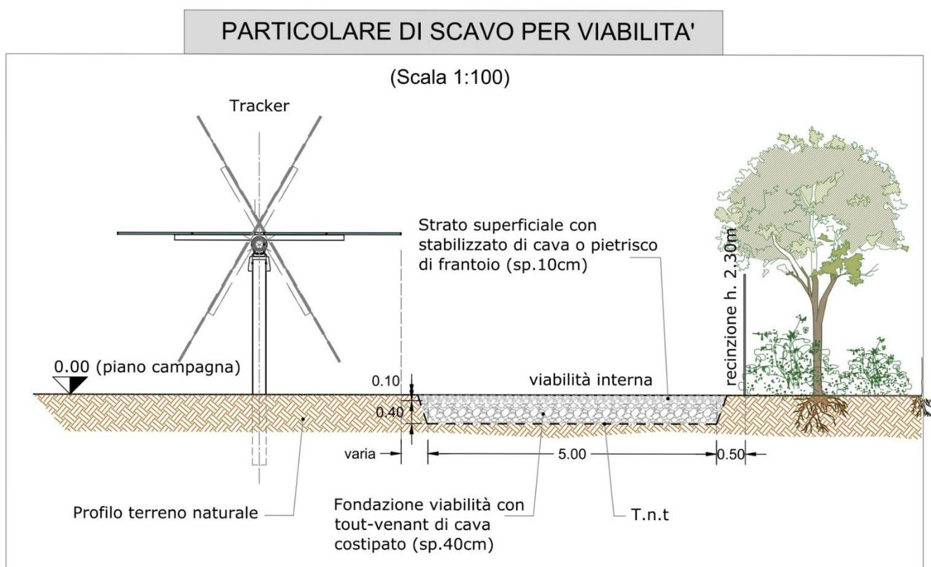
Figura 1 Sezione – particolare scavo e dettaglio recinzione
