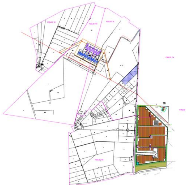
Figura 3 _ Cavidotto di collegamento alla nuova CP Terna
