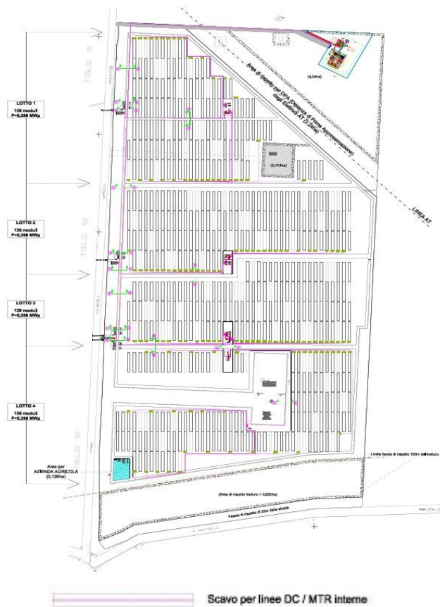
Figura 6: individuazione aree di scavo per le reti elettriche
