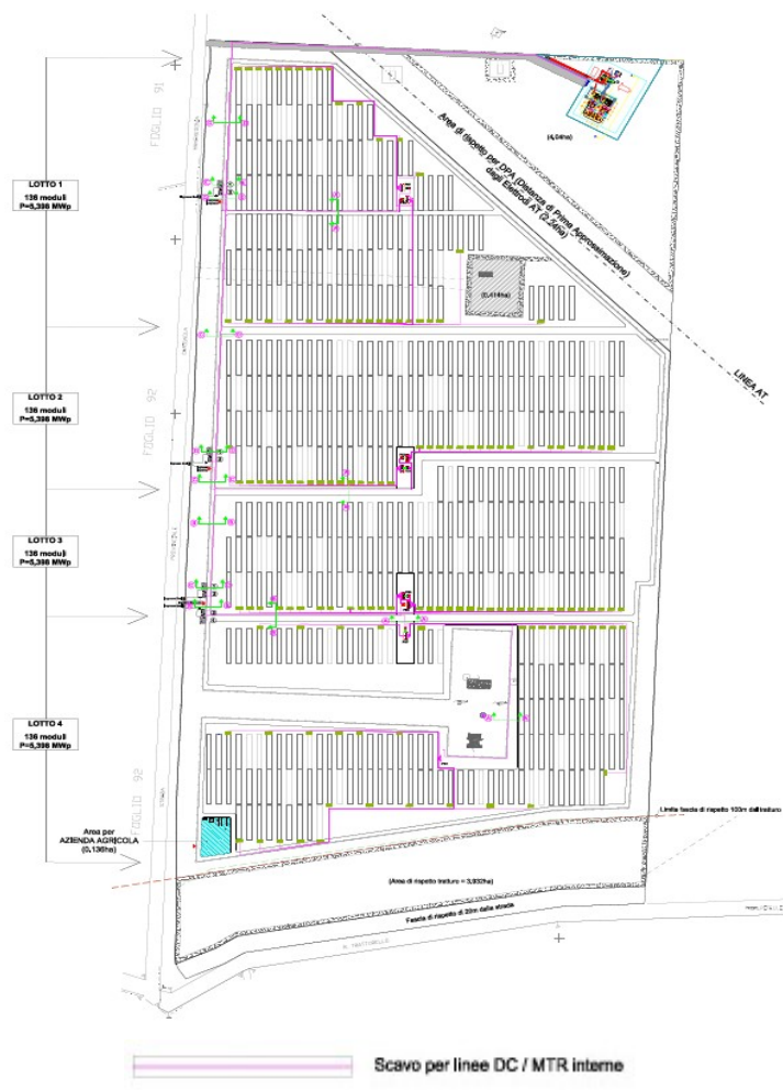
Figura 6: individuazione aree di scavo per le reti elettriche
