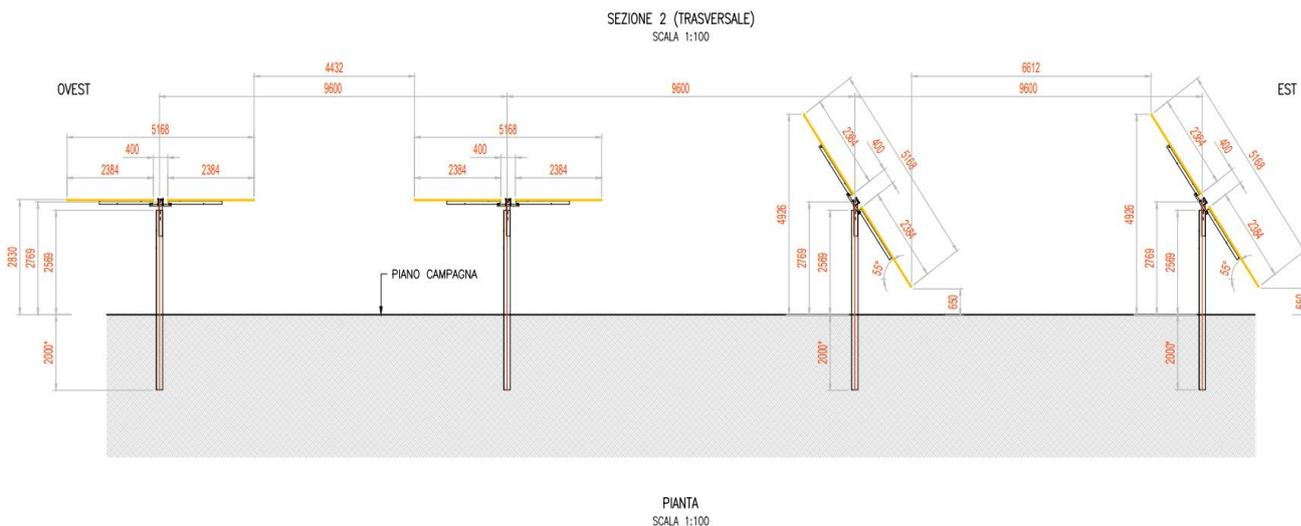
**Particolare strutture sostegno moduli pannelli e distanze di campo (interfila m 9,6)**
