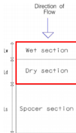
Figura 6.7: Modulo tipo, descrivente il modello concettuale idrologico dell'installazione di strutture fotovoltaiche a tracker su pali infissi comprendente l'area pannelli (in rosso) e l'area di interfila (Fonte: Hydrologic response of solar farm Cook 2013 American Society of Civil Engineers).
