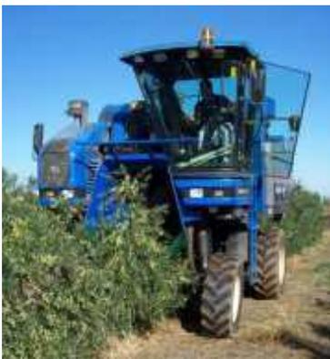
Fig.10: Macchina scavallatrice
