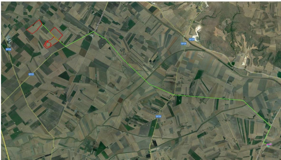
*Figura 2.2: Localizzazione dell'area d'intervento, tracciato di connessione, cabina trasformazione e punto di connessione. In rosso le sottoaree di progetto, in verde cavidotto MT, in azzurro cabina MT/AT e in viola cavidotto AT.*
