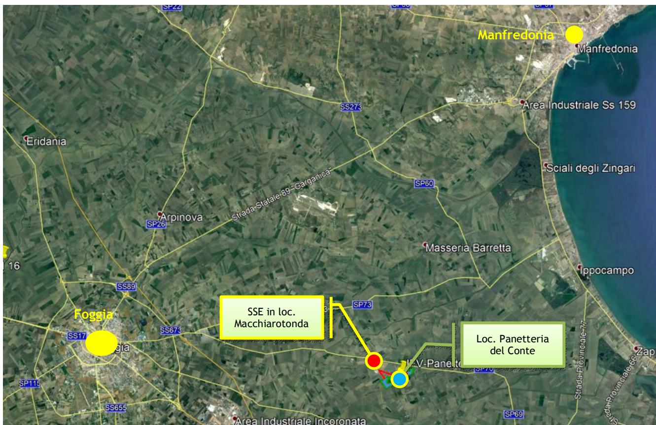
Fig. 2. Inquadramento di ampio raggio su ortofoto dell'area di intervento, situata all'incirca a circa 18km ad Est di Foggia, e circa 23km a SUD-Ovest di Manfredonia: a SUD, individuata con segnaposto azzurro, la centrale fotovoltaica; in rosso, il percorso dell'elettrodotto dorsale; a NORD, individuata con segnaposto rosso, il punto di connessione alla RTN.
