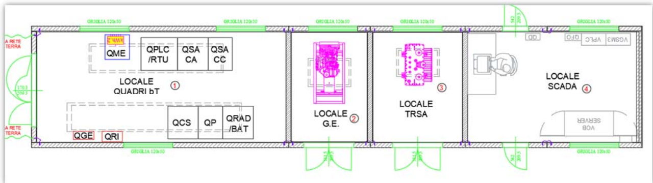
Fig. 18. Tipico PIANTA locali bT (dimensioni principali 15,00 x 3,00 x 4,50h)
